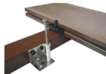
Nářadí: pila na dřevo, vrtáky. Ukončovací lišta se přichytává pomocí např. [nerez. vrutů V2A](#), kde si předvrtejte otvor 4 mm.
